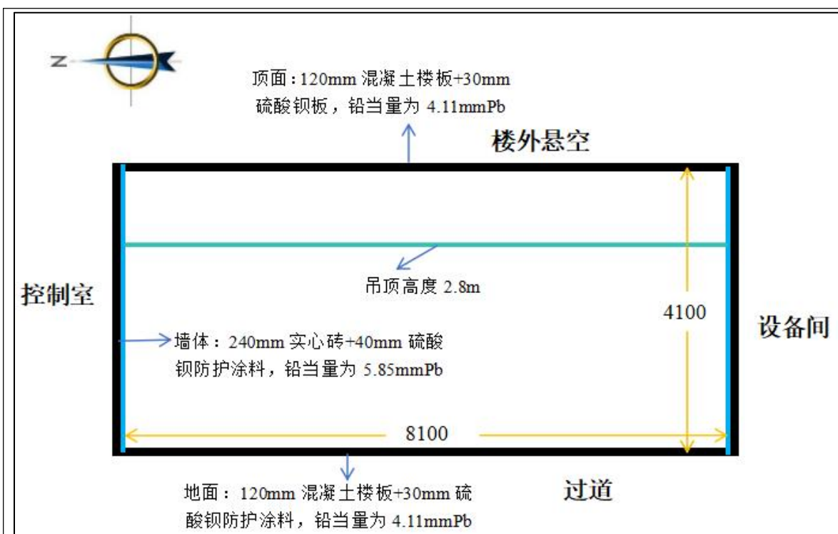
图 10-6 DSA 机房屏蔽剖面示意图
